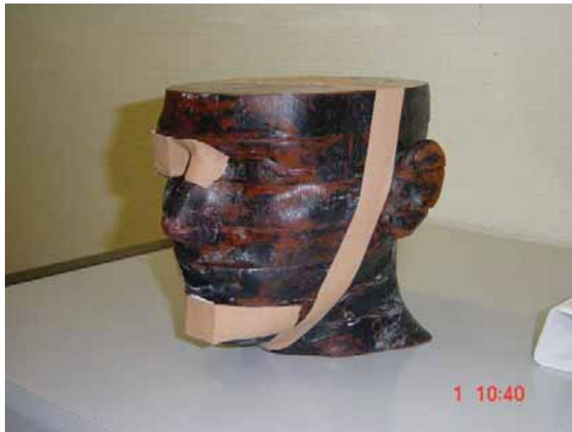
Bild 2: Das Rando- Alderson -Phantom
